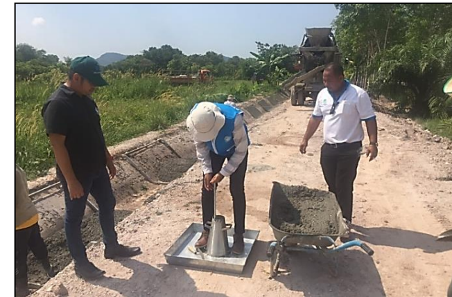
ทดสอบค่ายุบตัวของคอนกรีต (Slump Test)
