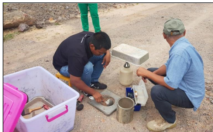
งานทดสอบความแน่นของดินในสนาม
